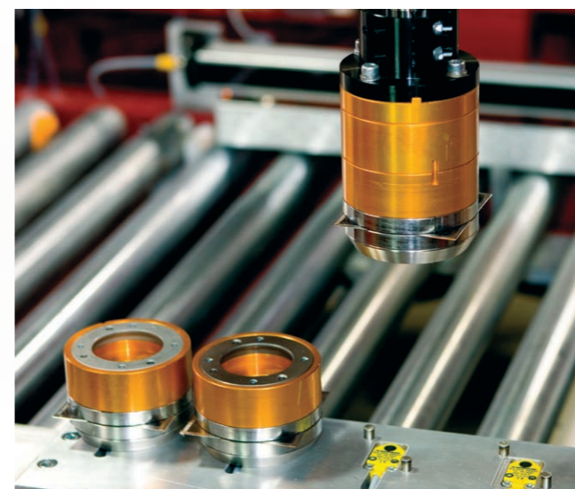
カスタムツールチェンジャーを使用した自動ボックスオープニングシステム
