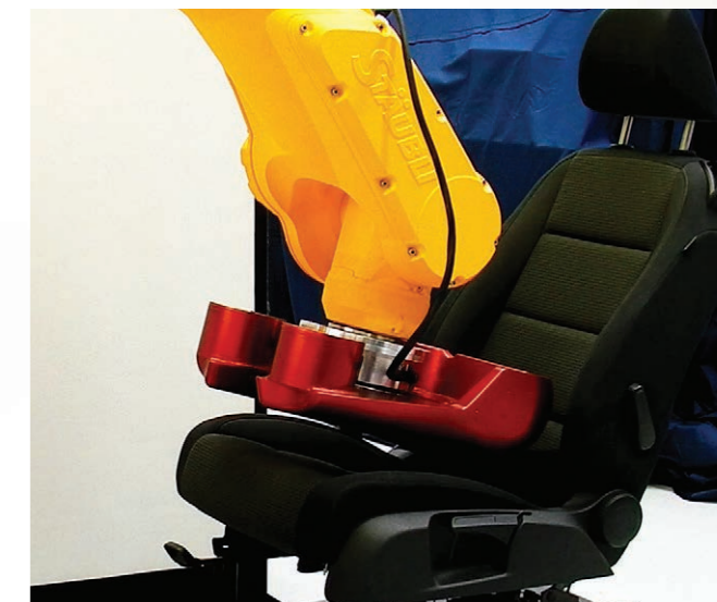
ATIのカトルクセンサーを使用した自動車用シートのテスト
