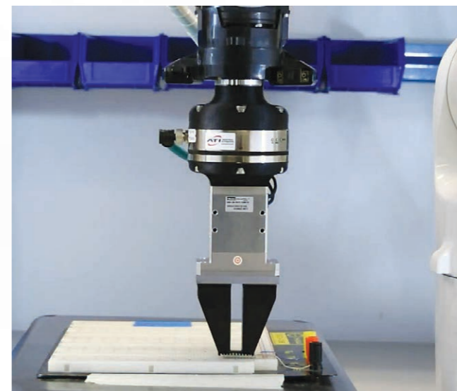
ATIのカトルクセンサーを使用した高精度電子アセンブリ
