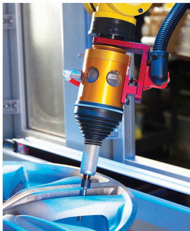
ATI RC-300バリ取りツールを使用した自動車用ホイールのバリ取り
